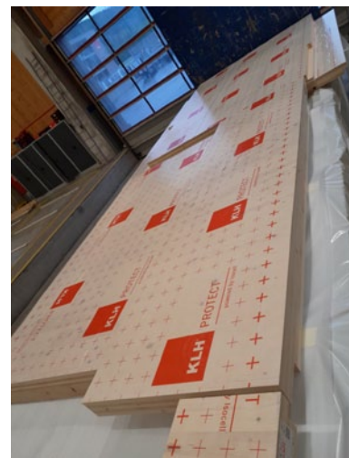
Abb. 14: KLH Protect in der Produktionshalle
