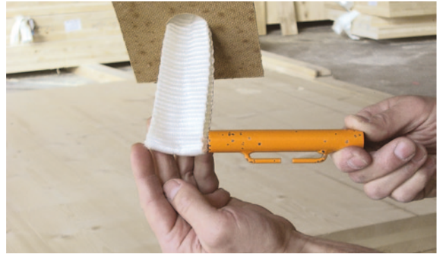
2. No colocar la costura en línea con el perno o gancho de elevación
