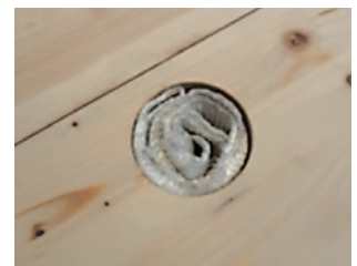
3. Situación de transporte con el lazo enrollado en el taladro
