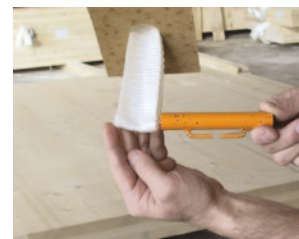
2. La costura del lazo no debe ponerse en el área del perno ni del gancho de elevación
