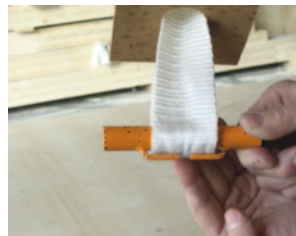
3. Poner el perno con la pinza de aseguramiento hacia abajo y colocarlo adecuadamente
