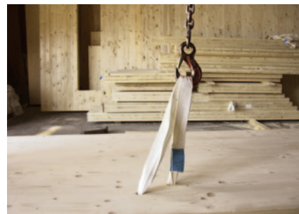
3. Situación de elevación con el sistema FD incorporado
