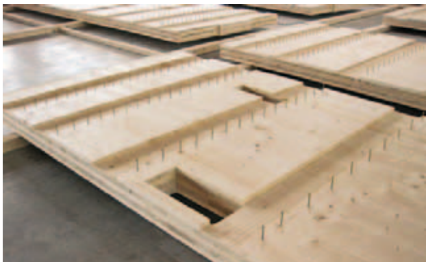
Éléments avec rainures et vis à bois comme sécurité contre la traction transversale
