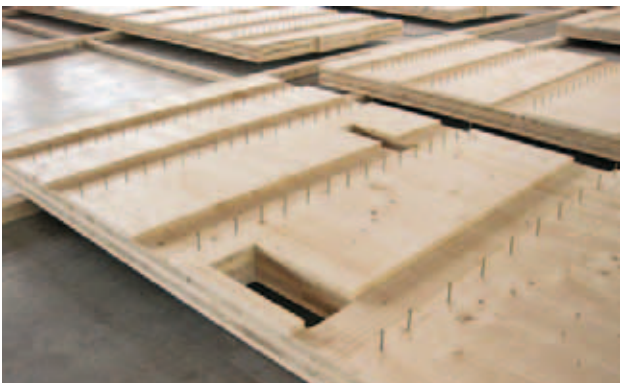
Elementos con entalles de embarbillado y tornillos para madera para asegurar la tensión transversal (ABA HOLZ van Kempen GmbH, www.aba-holz.de )
