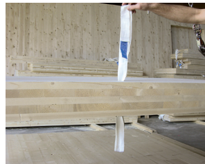
1. Schlaufe in Bohrung einsetzen
