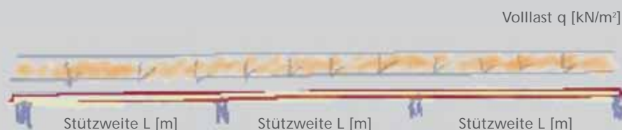
Dreifeldträger für Volllast für L/300 tel
